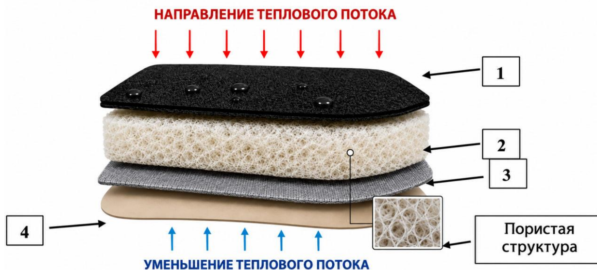
Рисунок 3. Схема многослойной системы материалов, сформированной для проведения исследования
