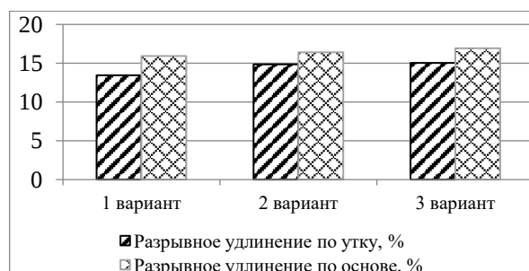
Рис.2. Изменение разрывного удлинения нитей основы и утка, использованной для огнестойкой ткани, полученной на основе эмульсии в различных вариантах.
