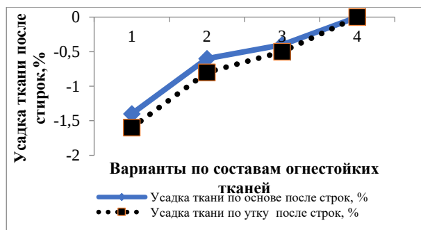
Рис. 8. Изменение усадки огнестойких тканей с различным волокнистым составом по основе и утку после стирки.
