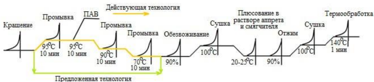
Рис. 14. Совмещенная технология периодического способа крашение – гидрофобная отделка – умягчение трикотажного полотна
