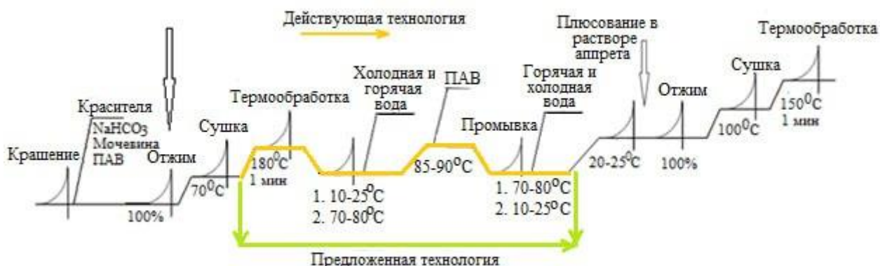
Рис. 13. Совмещенная технология непрерывного крашения и заключительной отделки хлопчатобумажной ткани
