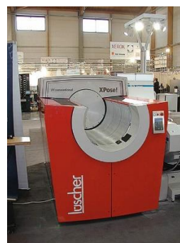
Rasm.1. a) Tashqi baraban tipidagi eksponirlash mexanizmining tuzilishi. b) Tashqi baraban texnologiyasi asosida ishlaydigan Xpose (Lüscher) uskunasi
