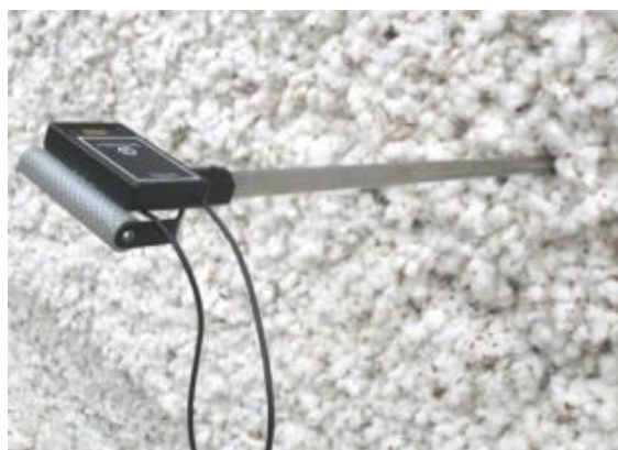
3-расм. КТ-1 электрон ҳарорат ўлчашгичда ғарамнинг турли нуқталаридаги температураларини ўлчаш жараёни
