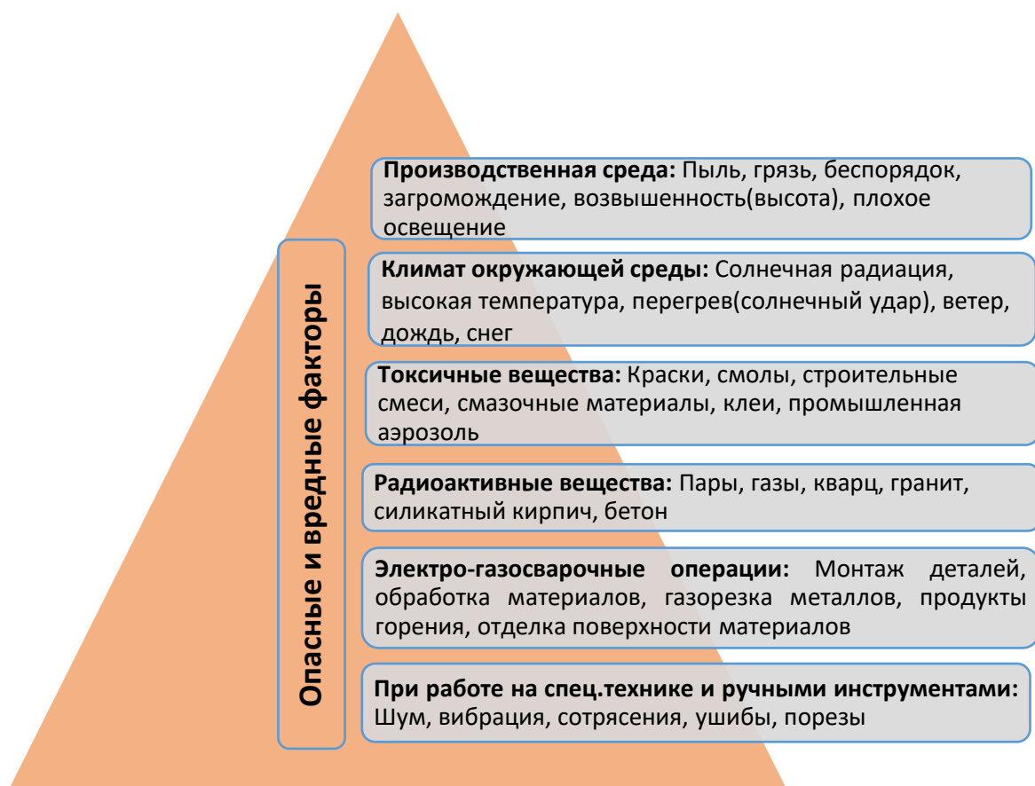
Рисунок 1. Опасные и вредные факторы строительных объектов
