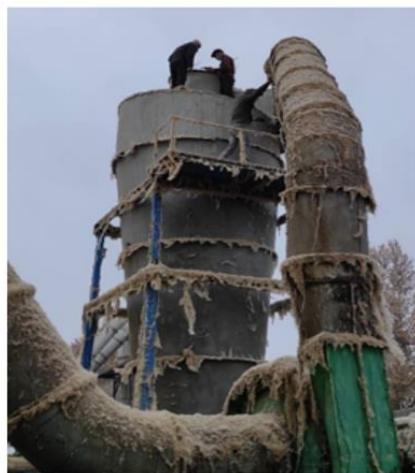
1-расм. "UK REAL AGRO COTTON" УК корхонасига тегишли жинлаш ускунасидан чиқадиган Ц-9 типдаги чанг ушлагич циклонининг иш жараёнидаги умумий тасвири
