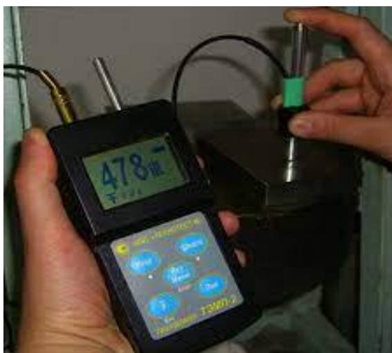
1-расм. Динамик қаттиқлик ўлчагичи ТЭМП-3
