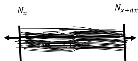
1 б-шакл. Чигитлар орасидаги толаларни ички зўриқиш кучлари ифодаси.
