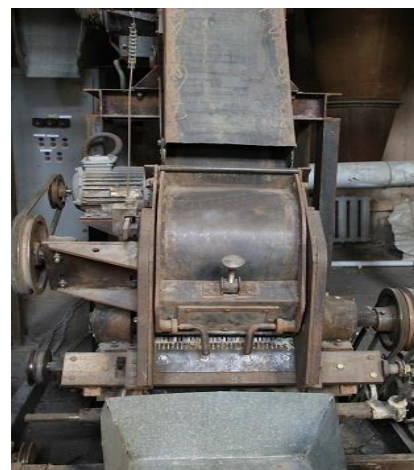
2- расм. Такомиллаштирилган аралаштиргичга эга бўлган 30 аррали 5ЛП линтернинг кўриниши.
