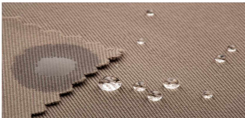
1-rasm. Matoning ichki va tashqi qatlamini suv shimish hususiyati [4].
