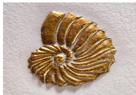
Рис. 1. Горячее тиснение с алюминиевой фольгой
