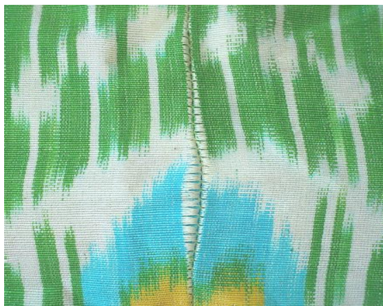
Рис. 2. Шов с раздвижкой нитей в среднем шве изделия из адраса
