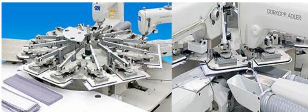
3-Rasm. “Durkopp Adler” korporatsiyasi 971-01 seriya avtomat stansiyasi.
