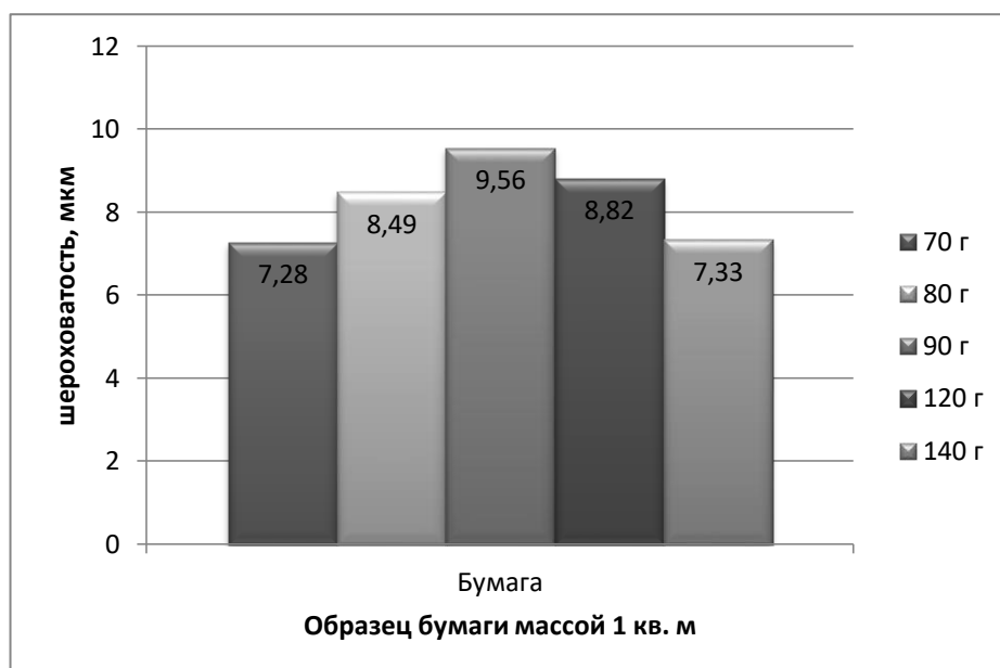
Рис. 1. Гистограмма значений шероховатости образцов исследуемой бумаги, измеренной на приборе Паркера
