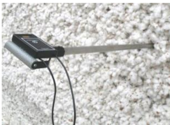
1-расм. КТ-1 электрон харорат ўлчашгичда ғарамнинг турли нуқталаридаги температураларини ўлчаш жараёни
