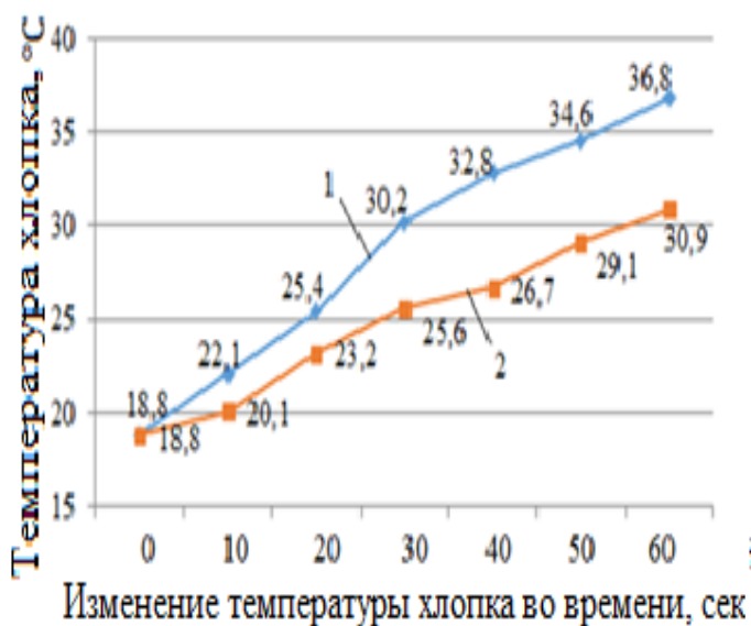
Рис. 11. Изменение температуры во времени при подаче горячего воздуха температурой 50°C в слой хлопка толщиной 0,1 м
