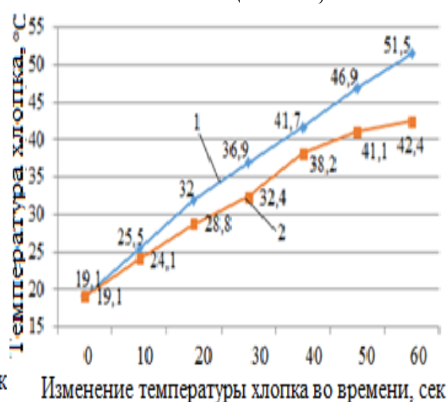
Рис. 12. Изменение температуры во времени при подаче горячего воздуха температурой 100°C в слой хлопка толщиной 0,1 м
