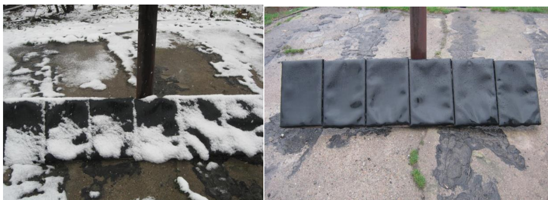
1-rasm. Tajriba va nazorat (tekshirish) uchun gidrofoblashtirilgan namunalarning atmosfera sharoitida 6 oy davomida (a — yanvar, b — iyun) saqlanish jarayonida olingan fotosuratlar.
