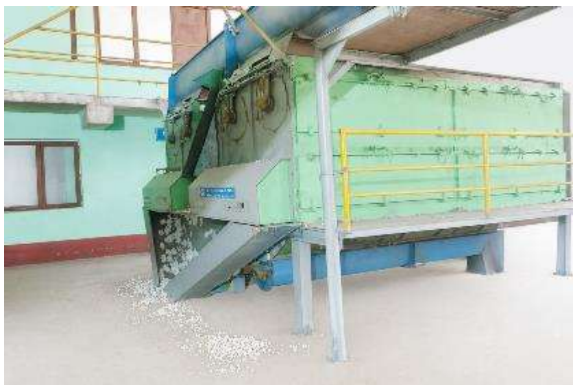
21-rasm. Qoziqchalari takomillashtirilgan 6A-12M1 shnekli tozalash uskunasi umumiy ko'rinishi
