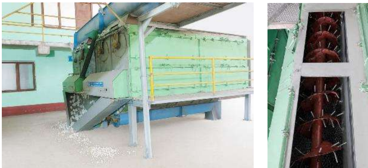
Рис. 21. Общий вид шнекового очистительного оборудования 6А-12М1 с усовершенствованными колками
