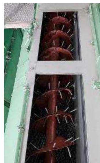
21-rasm. Qoziqchalari takomillashtirilgan 6A-12M1 shnekli tozalash uskunasi umumiy ko'rinishi
