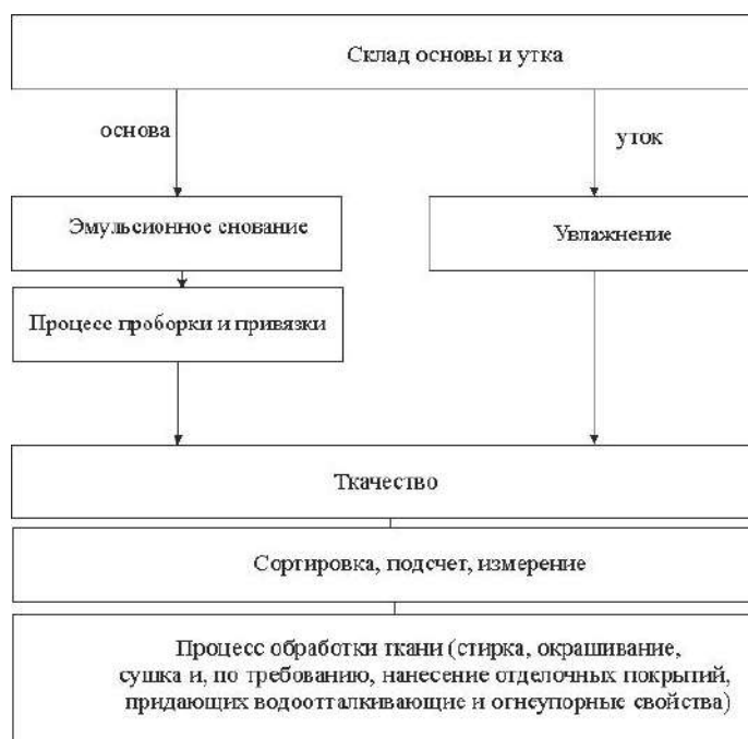
Рисунок 1. Последовательность технологического процесса производства рекомендуемой специальной одежды из ткани, содержащей вторичное сырьё
