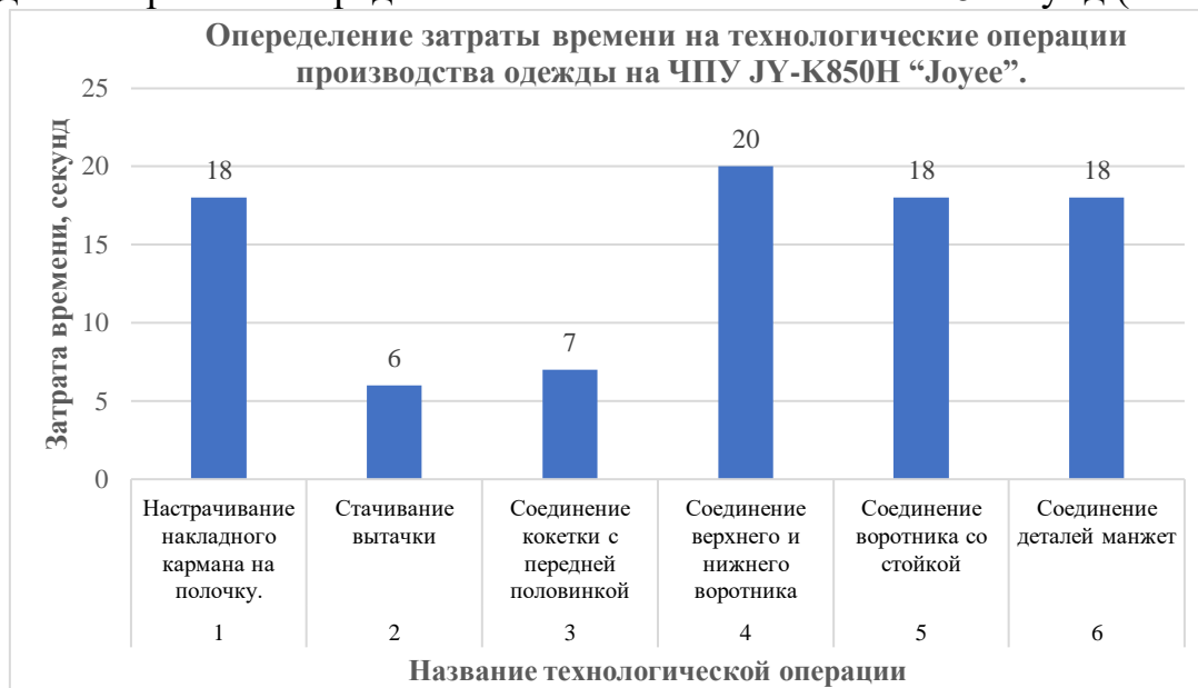
Рис. 3. Анализ времени обработки одежды на циклическом шаблонном автомате JY-K850H фирмы «Joyee».
