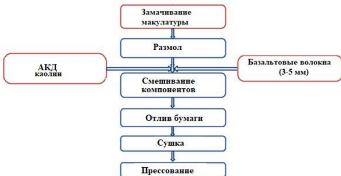
Рис.1. Общая технологическая схема изготовления бумаги с добавлением базальтовых волокон
