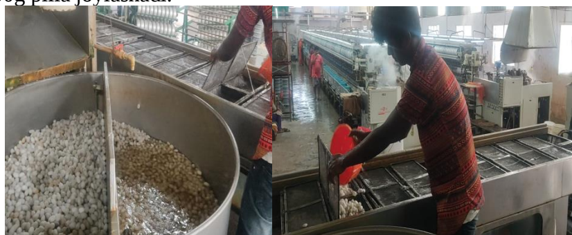
4-rasm. KZ-150-ShL pillani markazlashgan holda bug‘lash konveyeri
