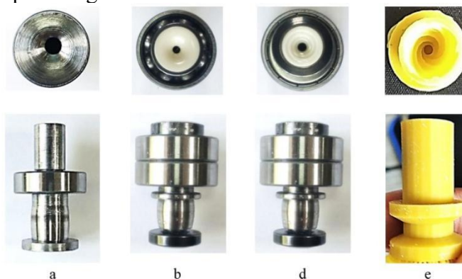
2-rasm. Yangi konstruksiyadagi ipga soxta buram beruvchi qurilmalar.
