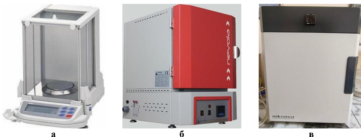
Рис. 1. Приборы для определения влажности и зольности бумаги:
