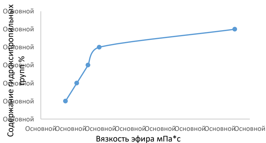
Рисунок № 2 Зависимость вязкости ГПМЦ от содержания гидроксипропильных групп
