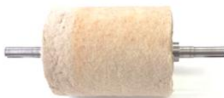
13–rasm. BM sukvo (movut) qoplamali val
