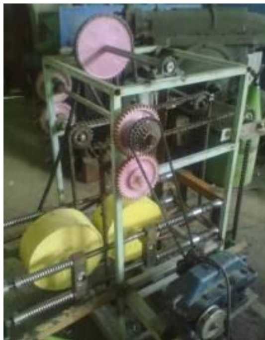
Рис. 17. Экспериментальный валковый стенд для отжима мокрого кожевенного полуфабриката (ИМ и СС АН Р Уз) по патенту АІР 04451
