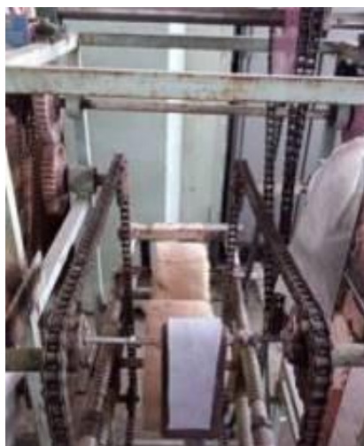
Рис. 18. Опытный стенд для отжима кожевенного полуфабриката с металлокерамической опорной плитой
