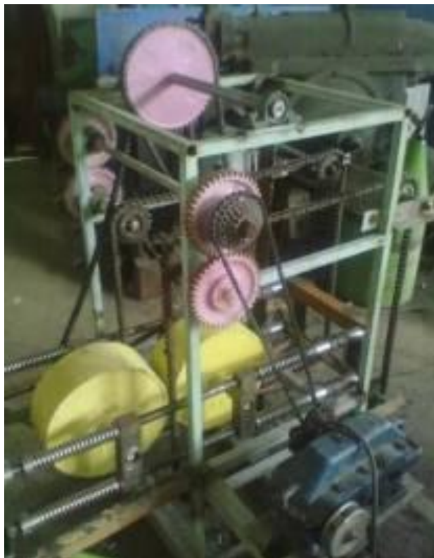
17-rasm. Nam yarim tayyor charm mahsulotlarini siqish uchun eksperimental valli stendi (Uz FA MISMI)
