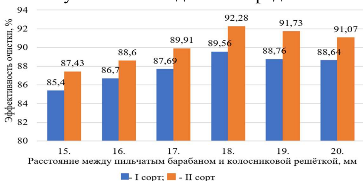
Рис. 16. Гистограмма изменения эффективности очистительной технологии при различных значениях зазора
