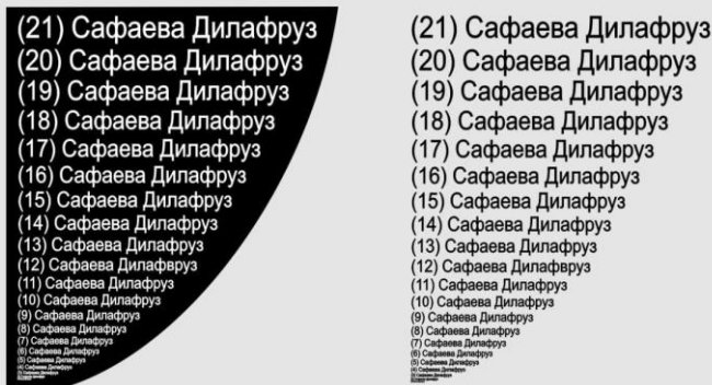
Рис. 4. Тест-объект для определения качества печати текста
