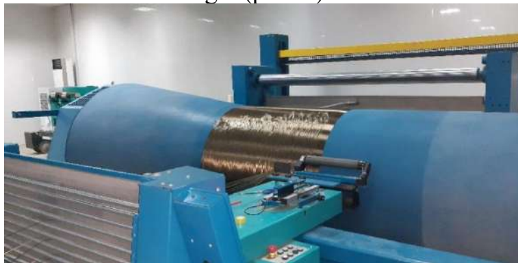
Рис. 6. Снование базальтовых нитей на ленточно-сновальной машине Benninger
