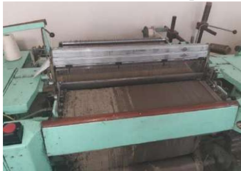
Рис. 8. Формирование базальтовой ткани на ткацком станке АТПР
