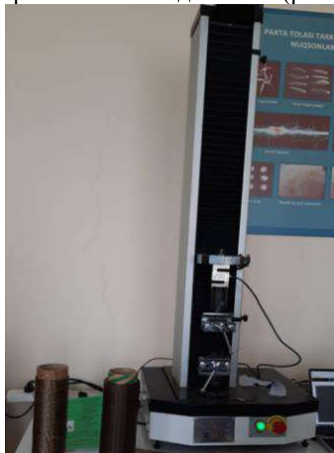
Рис. 4. Прибор WDW-5E для определения относительной разрывной нагрузки базальтовой ткани
