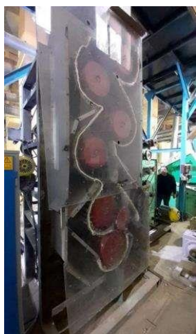
10-rasm. Vertikal iflosliklardan tozalovchi agregatning ko‘rinishi
