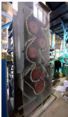
Рис. 10. Общий вид экспериментального стенда для очистки хлопка от мелких и крупных примесей
