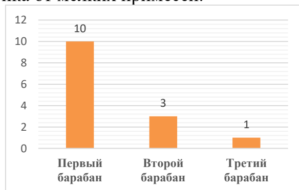
Рис. 9. Показатели изменения процента очищенного хлопка, возвращающегося на предыдущий барабан хлопкоочистительной машины с минимальной производительностью 4 т/ч
