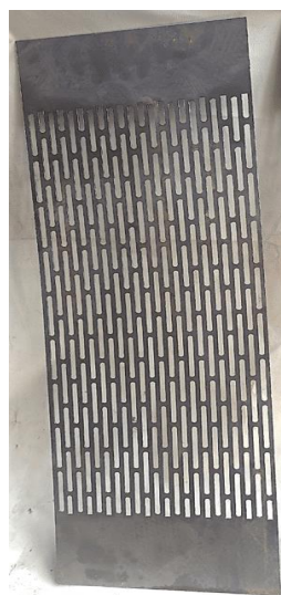
Вид сетки с вертикальными отверстиями
