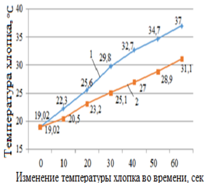
Рис. 9. Изменение температуры во времени при подаче горячего воздуха температурой 50°C в слой хлопka толщиной 0,05 м
