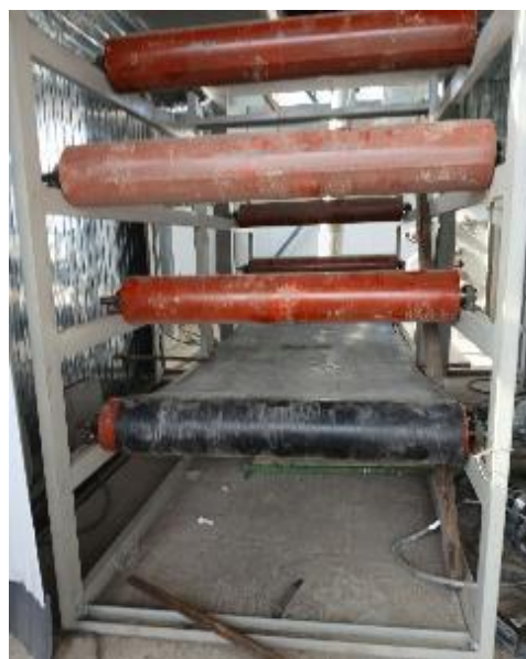
8-rasm. Takomillashgan quritish uskunasi tayyorlash jarayonidagi ko'rinishi
