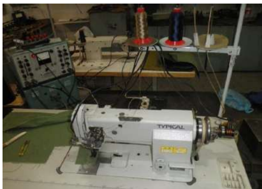
Рис.8 а, б. Общий вид швейной машины и электродвигателя с фрикционной муфтой.
