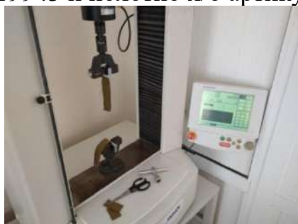
Рис.21. Общий вид установки для определения прочноститкани на разрыв
