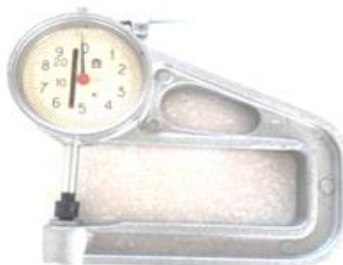
Иститувчи қатлам намуналарининг қалинлигини аниқлаш учун толшиномер (микрометр) дан фойдаланилди (2-расм).
