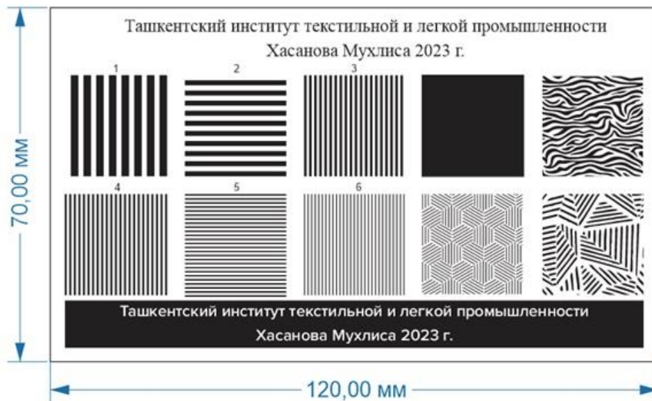
2-rasm. Issiq shtamplash orqali chop etilgan bosma mahsulot sifatini baholash uchun test-obyekt
