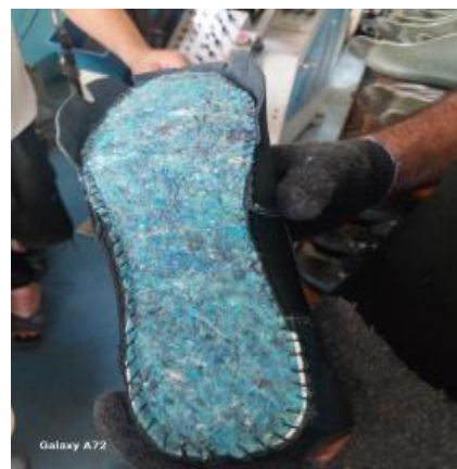
Рисунок 11. Эскиз модели спецобуви строчечно-литьевого метода крепления
