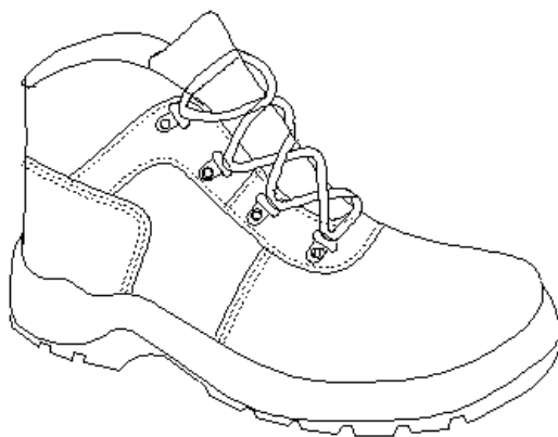
Рисунок 11. Эскиз модели спецобуви строчечно-литьевого метода крепления
