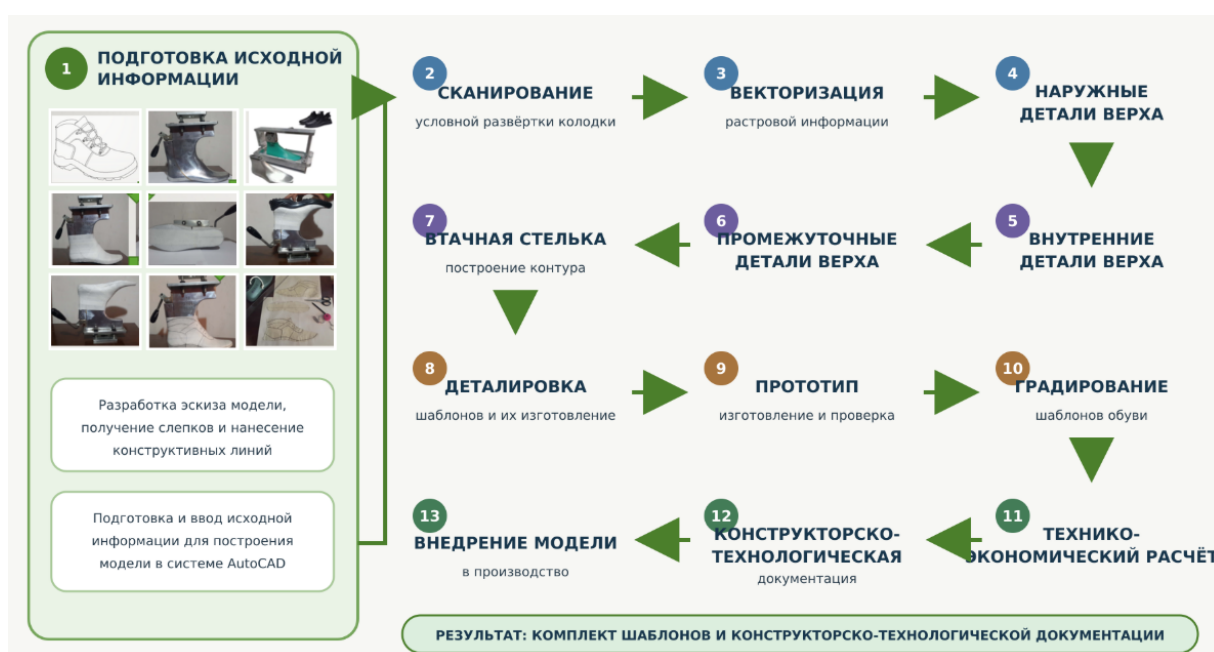
Рис.12. Схема процесса проектирования обуви литьевого метода крепления с использованием гравической системы AUTOCAD
