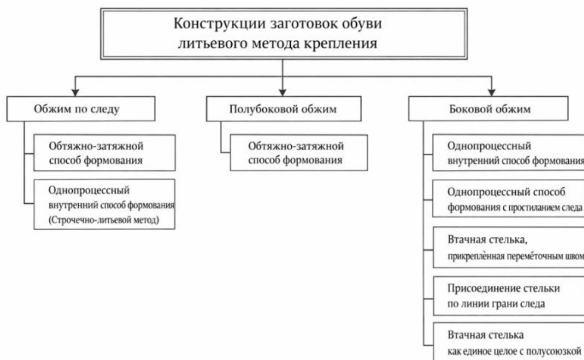
Рисунок 2. Основные конструкции обуви литьевого метода крепления
