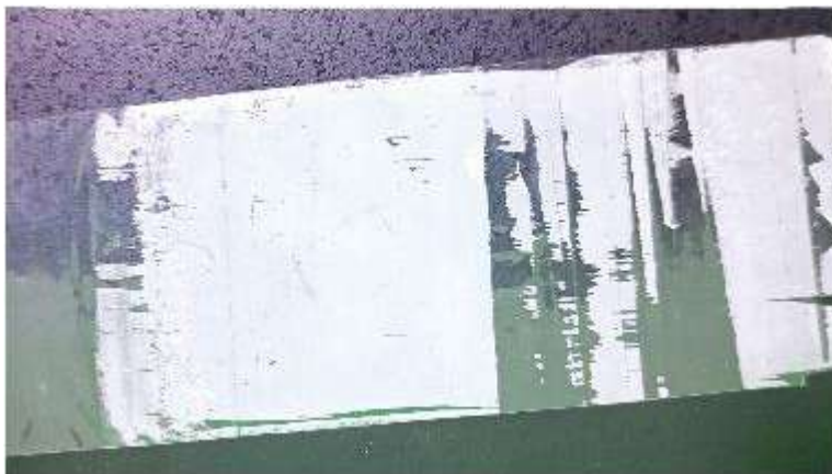
10-rasm. Namunalarni cho‘zilishga sinash jarayonida polipropilen qoplangan qog‘oz ichki yuzasining holati
