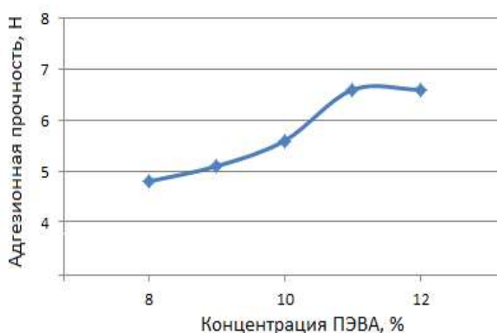
Рис. 1. Зависимость адгезионной прочности клеевого соединения ламинированной бумаги от концентрации PEVA
