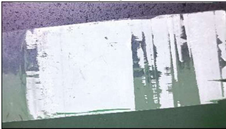
Рис. 10. Состояние внутренней поверхности бумаги, покрытой полипропиленовой плёнкой, в процессе испытания образцов на растяжение
