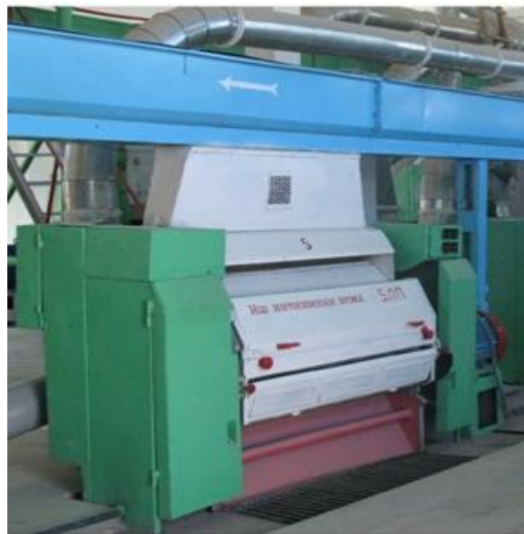
2- rasm. Quvursimon konstruksiyali val bilan takomillashtirilgan 5LP linteri
