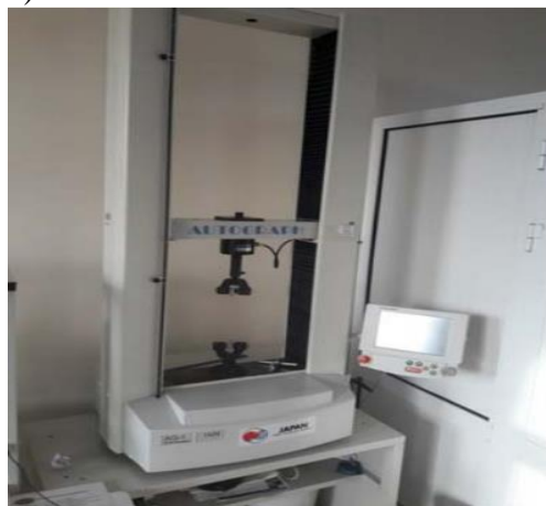
6-rasm. To'qimalarni uzish kuchi va uzilishdagi uzayish ko'rsatkichini aniqlochi AUTOGRAPHAG-1 uskunasida
