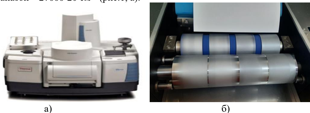
Рис.1. Внешний вид: а - ИК-Фурье спектрометра NICOLET iS50; б - пробопечатного устройства CB 100 color equipment
