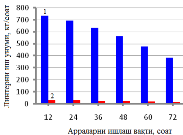
1- linterni chigit bo'yicha ish unumdorligi, kg/soat, 2- linterni momiq bo'yicha ish unumdorligi, kg/soat 1- rasm. Linterni chigit va momiq bo'yicha ish unumdorligini arralar ishlash vaqtiga bog'liqligi
