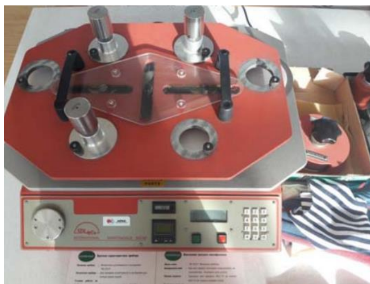
8-rasm. To'qimalarni ishqalanishga chidamliligini tekshiruvchi uskuna. International martindale Model M235/3
