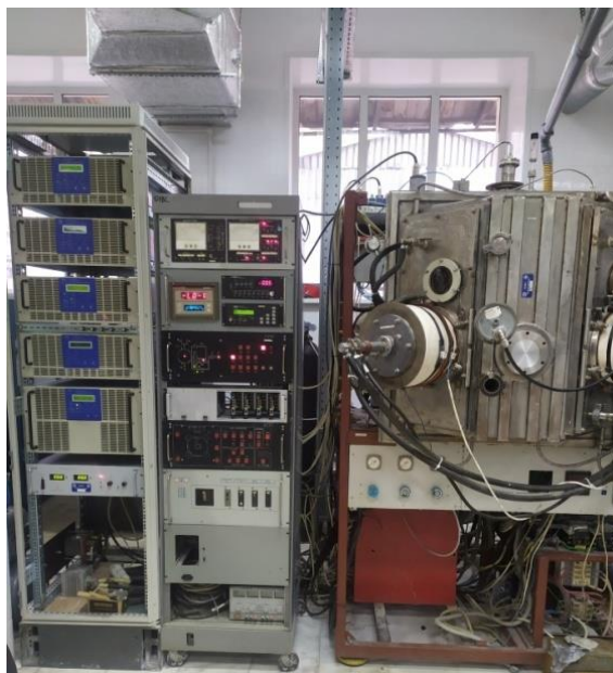
Рис.1. Установка для ион-азотирования АПП-2 производства МГТУ «СТАНКИН»
