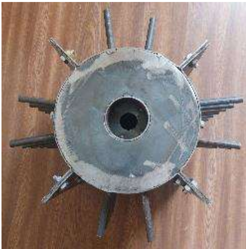
Общий диаметр колково-планчатого барабана составляет 400 мм, диаметр обшивки для установки колков — 240 мм, длина колков — 80 мм.
