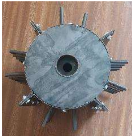
Общий диаметр колково-планчатого барабана составляет 400 мм, диаметр обшивки для установки колков — 270 мм, длина колков — 65 мм.
