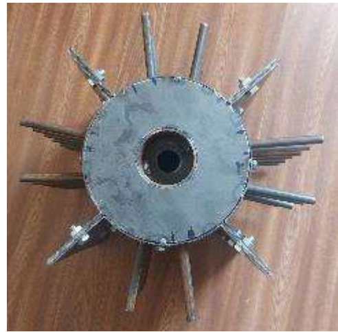
Общий диаметр колково-планчатого барабана составляет 400 мм, диаметр обшивки для установки колков — 210 мм, длина колков — 95 мм.
