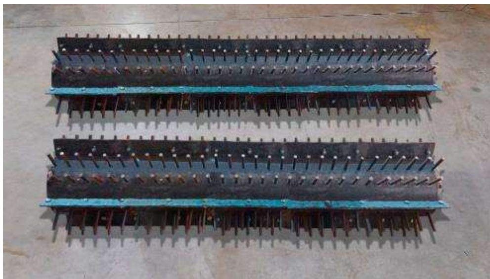
14-rasm. Paxtani mayda iflosliklardan tozalash uskunasiining takomillashtirilgan konstruksiyasiining sxemasi
