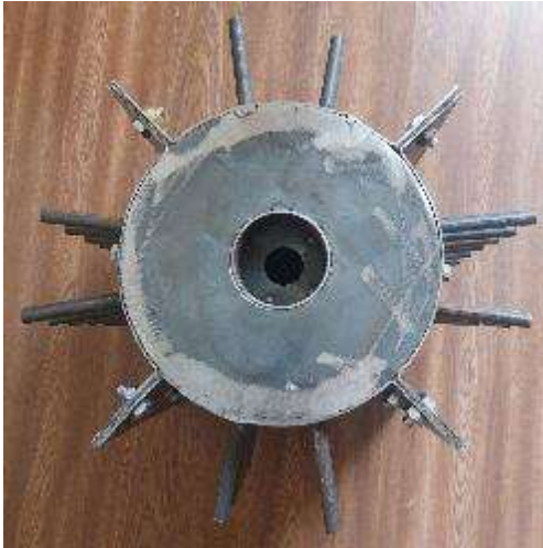
Qoziqchali plankali barabanning umumiy diametri 400 mm, qoziqchalar oʻrnatiladigan qoplamaning diametri 240 mm, qoziqchalarning uzunligi 80 mm
