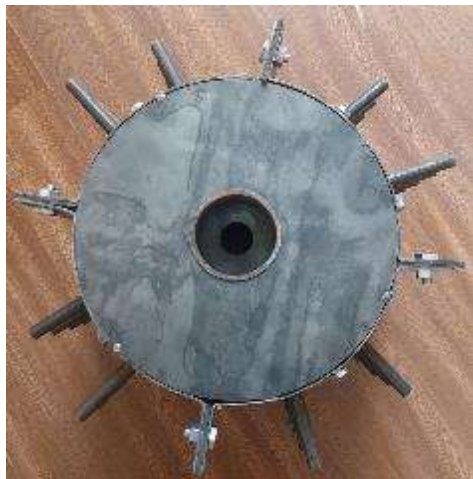
Общий диаметр колково-планчатого барабана составляет 400 мм, диаметр обшивки для установки колков — 300 мм, длина колков — 50 мм (существующий вариант).
