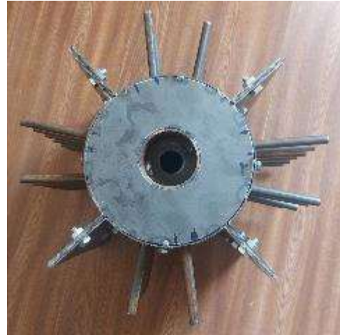
Qoziqchali plankali barabanning umumiy diametri 400 mm, qoziqchalar oʻrnatiladigan qoplamaning diametri 210 mm, qoziqchalarning uzunligi 95 mm
