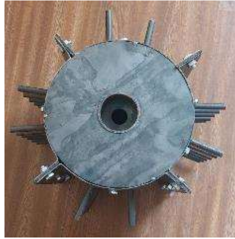
Qoziqchali plankali barabanning umumiy diametri 400 mm, qoziqchalar oʻrnatiladigan qoplamaning diametri 270 mm, qoziqchalarning uzunligi 65 mm
