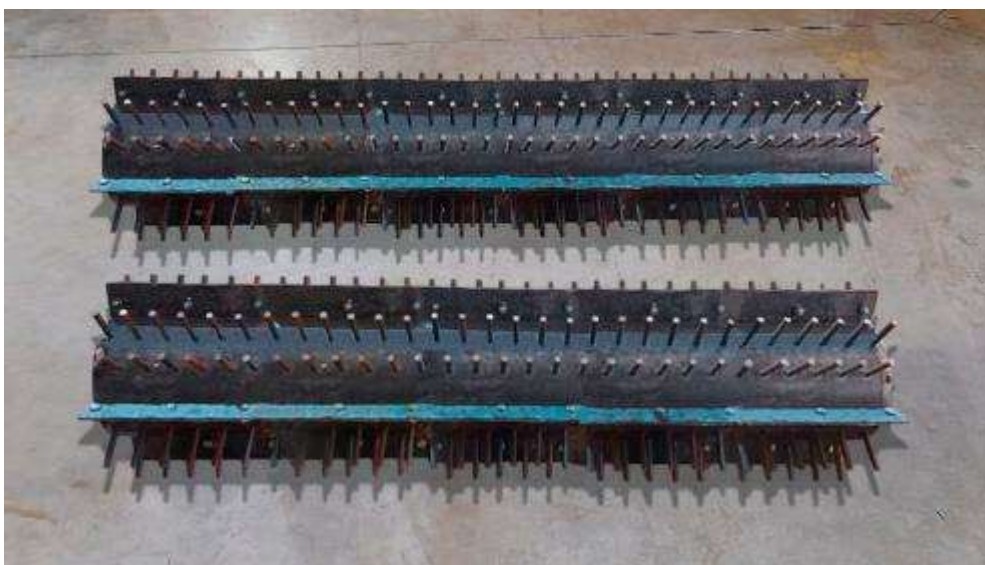
Рис.14. Схема усовершенствованной конструкции оборудования для очистки хлопка от мелких примесей
