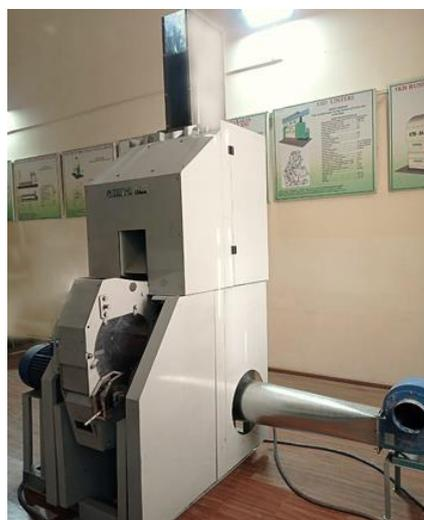
**Рисунок 7. Лабораторная установка 10 пильного джина, оснащенная усовершенствованной рабочей камерой**
