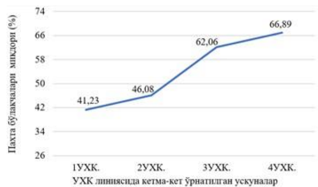
2-расм. УХК тозалаш линиясининг секцияларида ажралган ифлосликлар таркибдаги пахта бўлақчаларининг миқдорини ўзгариши
