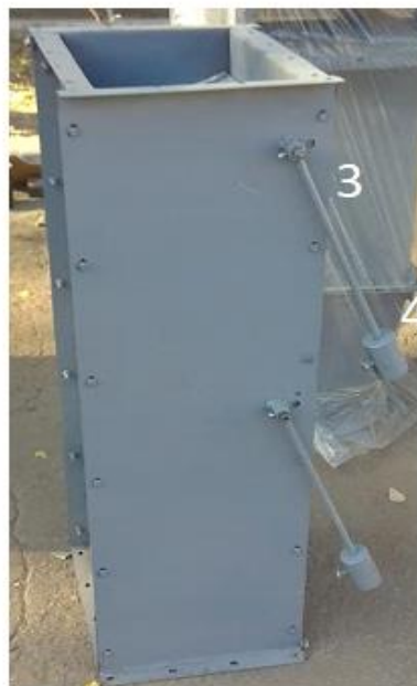
2-расм. Таклиф этилган оғир аралашмаларни узлуксиз чиқариш чўнтак мосламаси.
