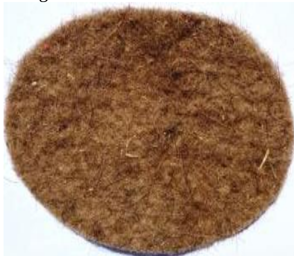
1-rasm Igna sanchiq usuli bilan tuya junidan olingan notoʻqima mato tasviri
