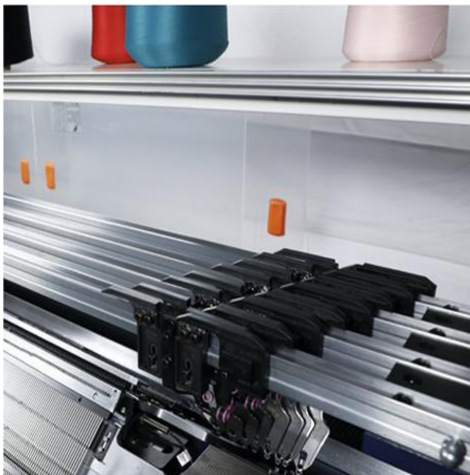
Рис.2. Система (механизм) нитеводителей пряжи автоматизированной плосковязальной машины «GUOSHENG» GSJX-2-52
