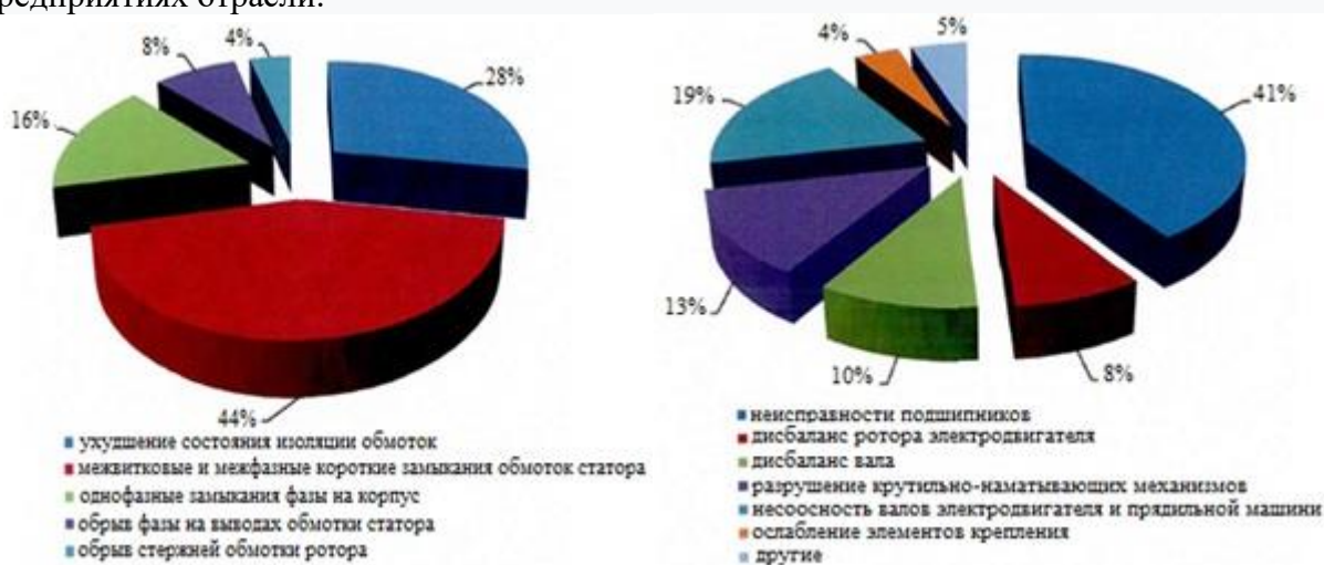
Рис.1. Статистика наиболее часто возникающих электрических (а) и механических (б) повреждений в прядильных агрегатах
