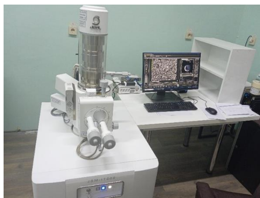
Рис.1. Принципиальная схема и внешний вид сканирующего электронного микроскопа JEOL JSM-IT200
