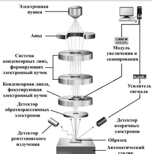
Рис.1. Принципиальная схема и внешний вид сканирующего электронного микроскопа JEOL JSM-IT200
