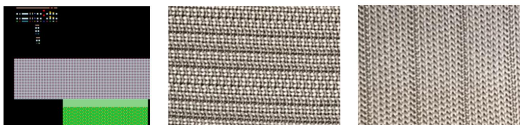
Рисунок 5 – Платированное рибовое переплетение 1×1 (flat knit rib structure).
