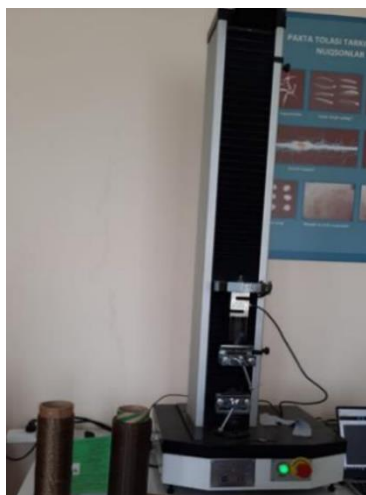
Рис. 3. Прибор WDW-5E для определения относительной разрывной нагрузки нитей и тканей
