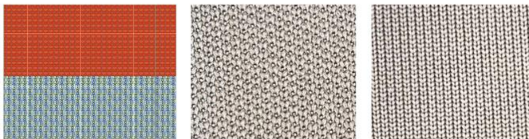
Рисунок 4 -Двухфонтурное комбинированное прессово-ластичное поперечновязаное трикотажное полуфабрикат заготовки обуви с регулярным мелкоряпортным рисунком.
