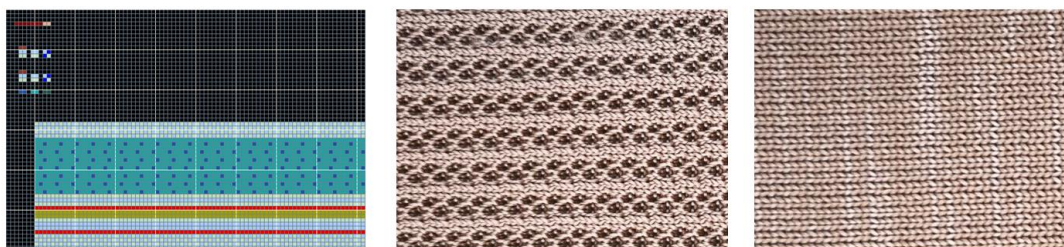
Рисунок 3- Платированное кулирное переплетение с tuck-структурой (2-feed plated tuck knit);
