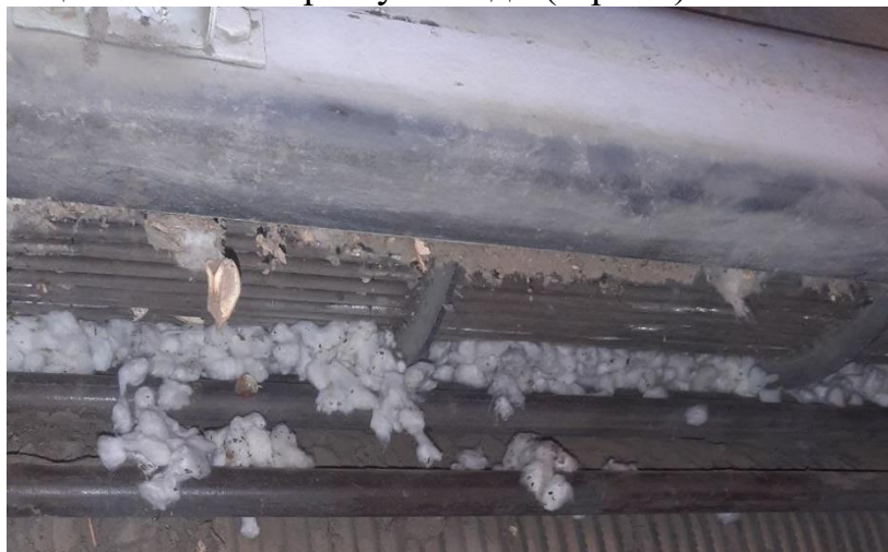
1-расм. Узун қозикли барабан кожухи билан биринчи аррали барабаннинг илаштирувчи колосниклари орасидаги масофани 40 мм га тенг бўлганида ораликда пахтани қисилиб қолиш ҳолатлари.
