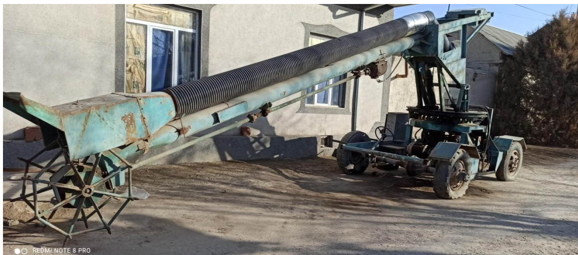
1-расм. Тавсия этилган пахта ғарамини бузгич машинаси кўриниши.
