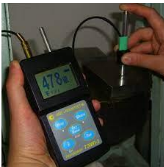
2-расм ТЕМП-3 русумидаги динамик қаттиқлик ўлчагичи
