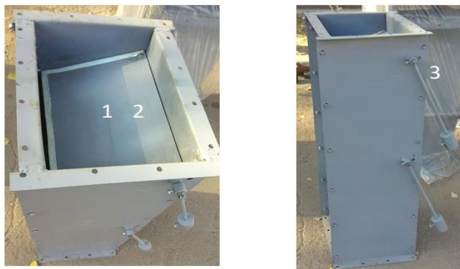
3-расм. Таклиф этилган оғир аралашмаларни узлуксиз чиқариш чўнтак мосламаси.
