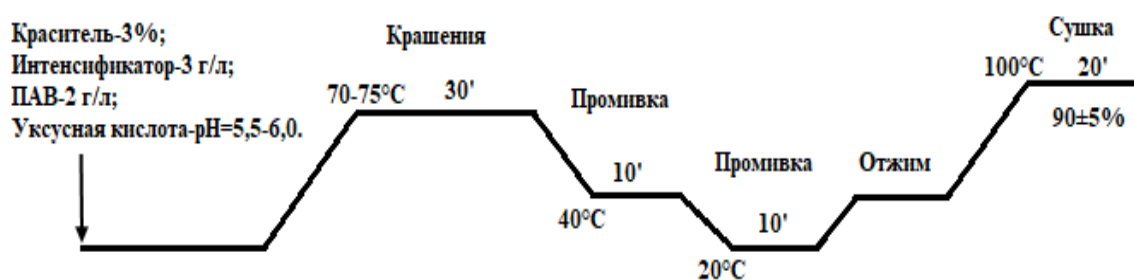
Рис. 6. Технологический режим процесса крашения композиционных волокон в соотношении ППЭТ:ВПЭТ 70:30
