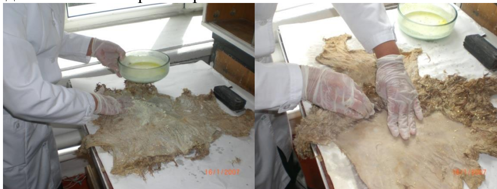
Рисунок-1. Применение сульфидно-полисульфидных растворов натрия в качестве обезваляющего раствора при снятие шерсти из овечьей кожи
