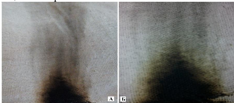
Рис.1. Внешний вид образцов после воздействия пламени с пропиткой TEX-1 (а) и с пропиткой TEX-2 (б)
