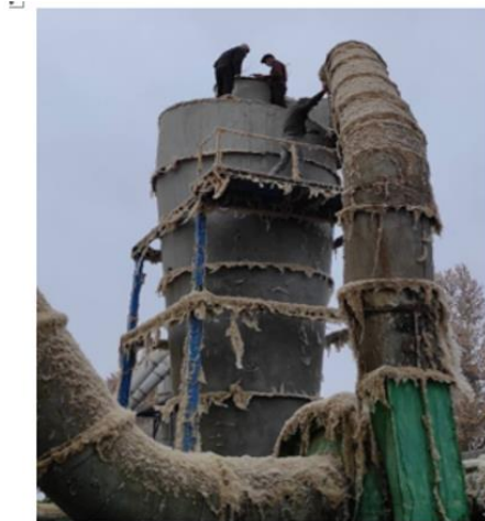
1-расм. "UK REAL AGRO COTTON" УК корхонасига тегишли жинлаш ускунасидан чиқадиган Ц-9 типдаги чанг ушлагич циклонининг иш жараёнидаги умумий тасвири
