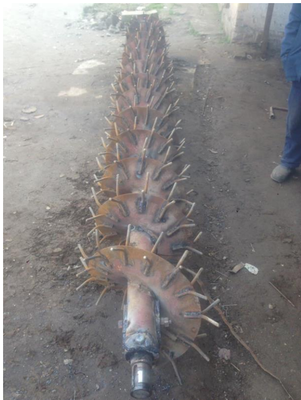
1-rasm. Takomillashtirilgan vintli konveyerning 6A-12M uskunasiga oʻrnatilgan holatdagi umumiy koʻrinishi.
