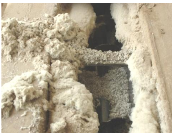
Рис.3. Условия работы подшипников в загрязненной среде.
