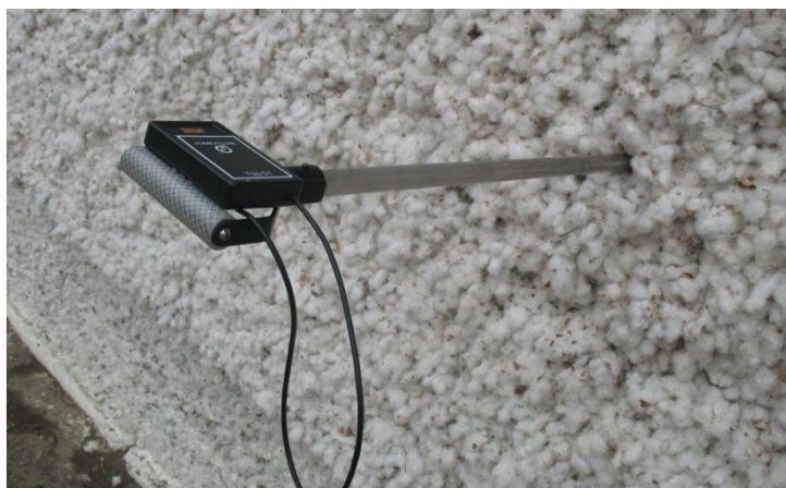
2-rasm. G'aramda saqlanayotgan paxtani haroratini o'lchash.
