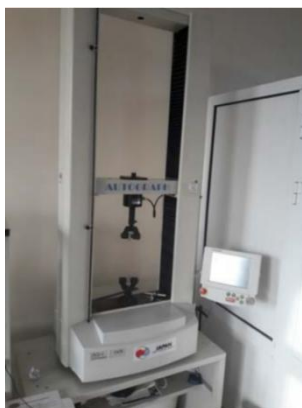
1-rasm. To'qimalarni uzish kuchi va uzilishdagi uzayish ko'rsatkichini aniqlashi AG-1 uskunasida
