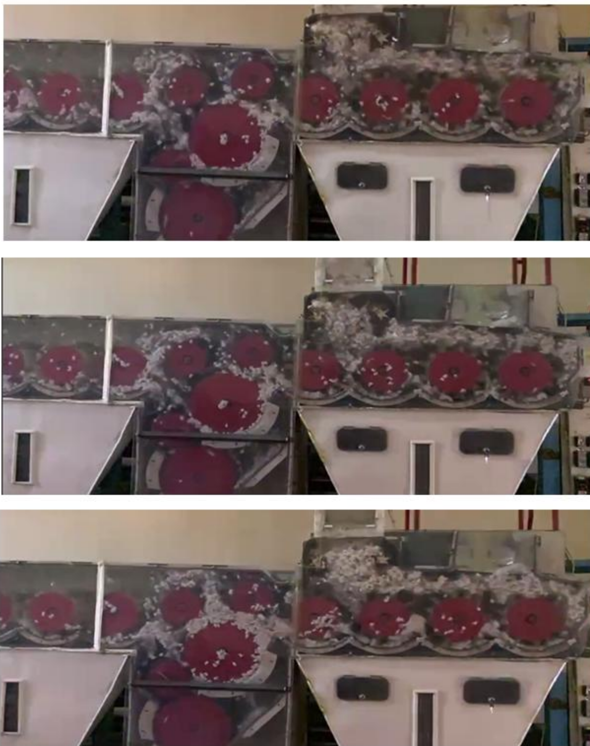
1-rasm. UXK tozalash oqimida paxtani tiqilish jarayoni.
