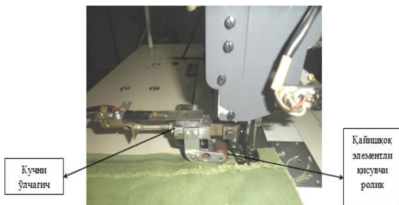
3-расм. Тикилаётган брезент материални зичловчи роликнинг умумий кўриниши
