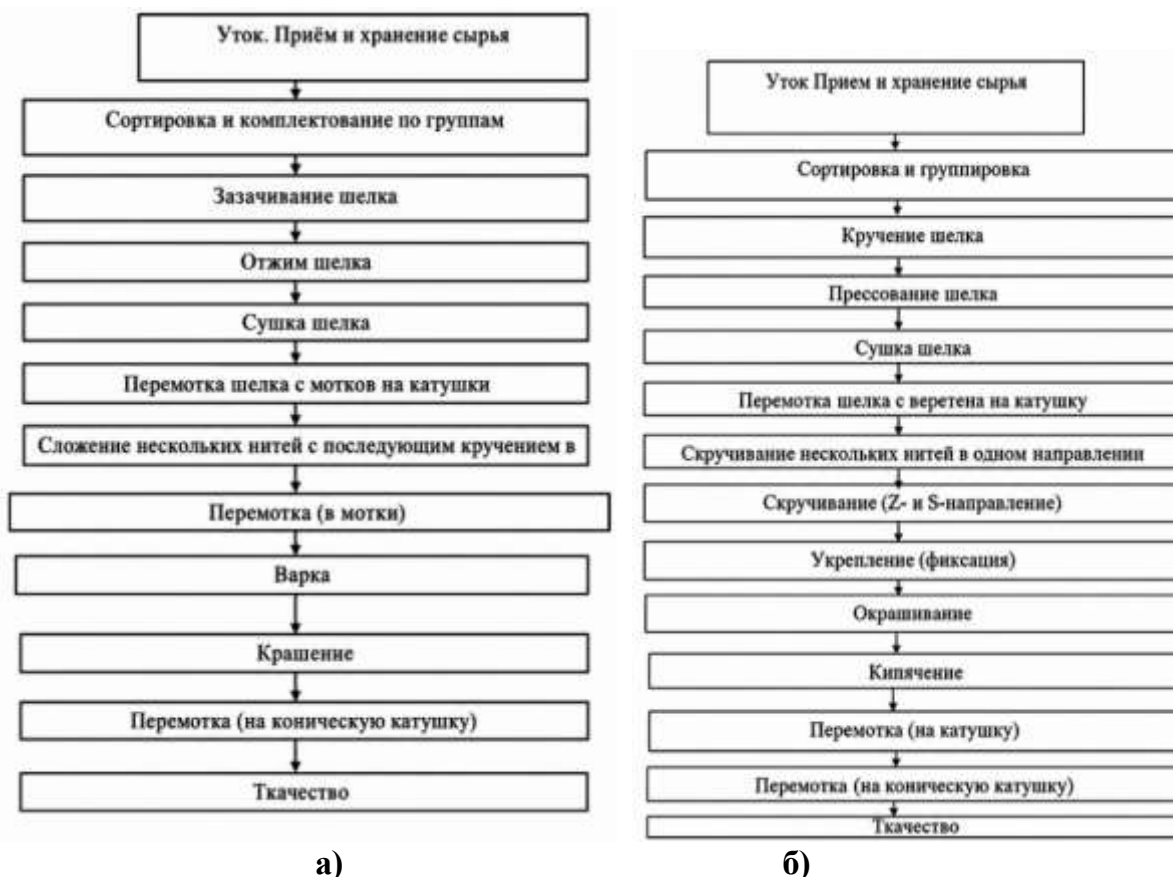
Рисунок 9. Существующая технология подготовки уточной нити к ткачеству: традиционная — а, новая — б; последовательность процессов
