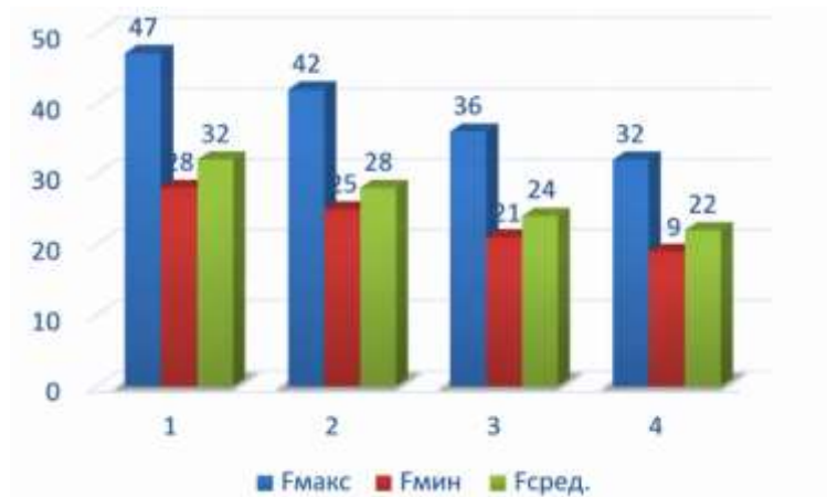
Рисунок 7. Гистограмма натяжения уточных нитей на жаккардовом ткацком станке
