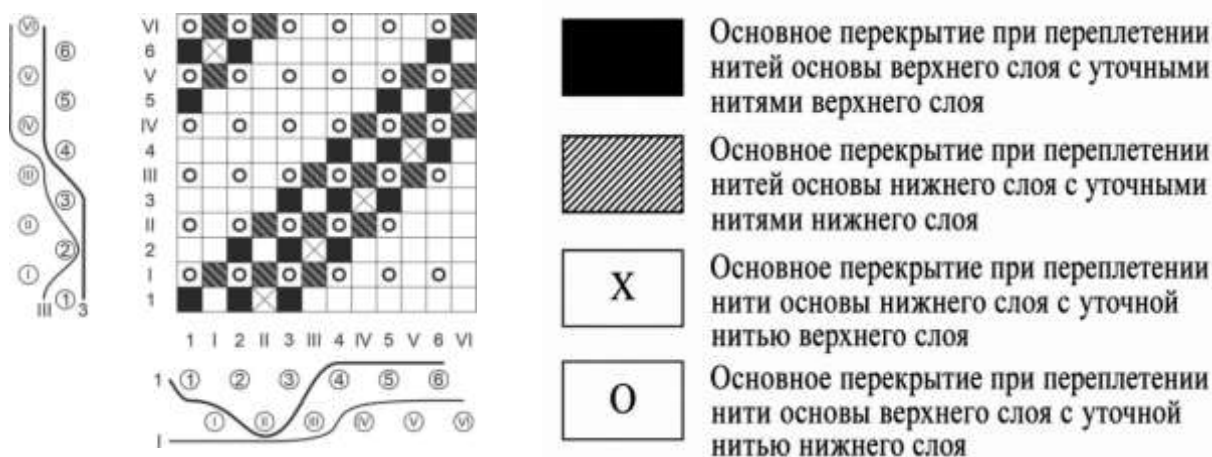
Рисунок 10. Изображение рисунка, полученного способом соединения сверху вниз нитей основы верхнего слоя с уточной нитью нижнего слоя
